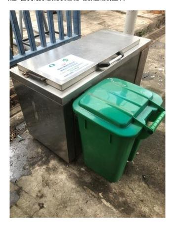
由 2020 年 1 月份起因新冠疫情的關係,學校停止面授課堂及寄宿, 廚房亦停止運作,由於廚餘機長時期放置於戶外,機身及鉸位嚴重鏽蝕, 摩打不能轉動,部分零件如轉動鐵桿亦已損毀,並沒有零件更換,加上 早前受颱風侵襲,由於校舍位於海邊,校內很多設施亦嚴重損毀,當中 包括廚餘機亦受影響,故當時誤將廚餘機與其他受損毀的設施一併棄 掉。
